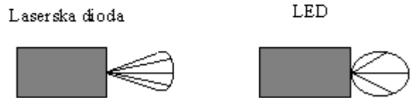
Slika 7 Različiti radijacioni uglovi između LED i laserske diode.
